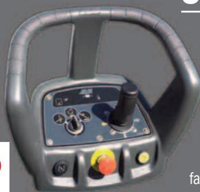
Los controles desmontables de la plataforma brindan desplazamiento y ubicación de la pluma más rápidos y eficientes controlando con una sola mano todas las funciones de la pluma. Los botones e interruptores de control en tierra cuentan con gráficos de alto contraste. Los símbolos gráficos facilitan la identificación de los controles y contribuyen a reducir el tiempo de capacitación de los operadores.
