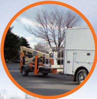
La orientación de la pluma ayuda a proteger la canastilla durante el remolque (la canastilla se ubica sobre el lado del enganche)
