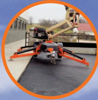
Fácil de instalar gracias a los estabilizadores hidráulicos autonivelantes
